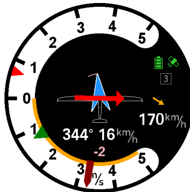
Abbildung 23: Anzeige des Energy Arrow im Flug
