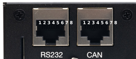
Abbildung 4: Die RJ45 Anschlüsse im Detail
