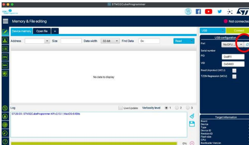
**Schritt 4:** Klicke auf „Open file“ und wähle die Update-Datei (kann hier heruntergeladen werden: [https://github.com/larus-breeze/sw\\_sensor/releases](https://github.com/larus-breeze/sw_sensor/releases); Dateienendung .elf) aus, klicke auf öffnen:
